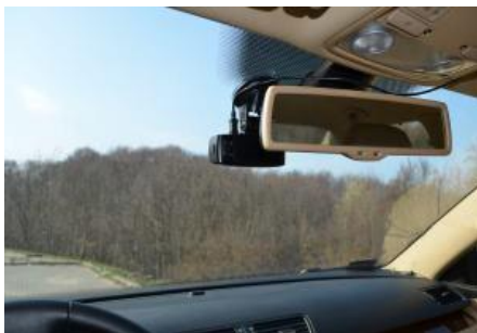
Przykład zamontowania rejestratora FX212/222 w samochodzie
