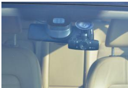
Przykład zamontowania rejestratora FX212/222 w samochodzie
